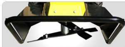
Dvojna rezila na dveh višinah.
